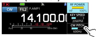
4. Ruotare **[MULTI]** per impostare il passo CW su un valore tra 300 e 900 Hz (in passi di 5 Hz).
