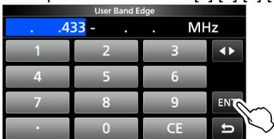
4. Inserire la frequenza del limite banda superiore, quindi toccare [ENT]. (Esempio: 439,9)
