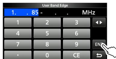
5. Inserire la frequenza del limite banda superiore, quindi toccare [ENT]. (Esempio: 1,95)
